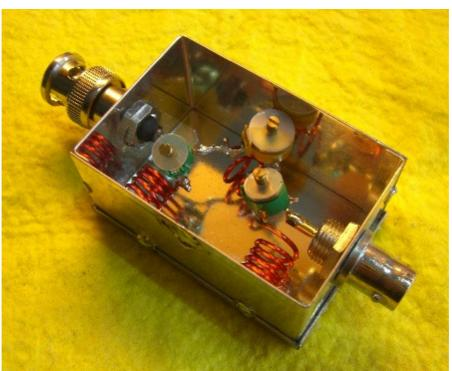
La **costruzione** del filtro è piuttosto semplice: bastano tre bobine e tre condensatori per costruire un filtro a tre stadi. Il primo e il terzo sono LC serie, il secondo LC parallelo. Si inscatola il tutto in un piccolo contenitore per radiofrequenza, con una coppia di connettori (maschio e femmina), ed il gioco è fatto, almeno in teoria. Lo schema:
